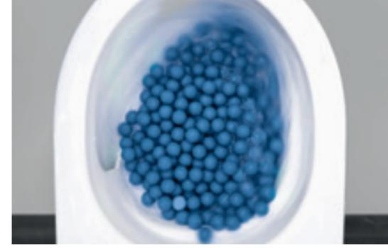
Lors des tests, jusqu'à dix fois plus de balles d'essais étaient évacuées que ne l'exigent les essais normalisés (DIN EN 997-2018).
